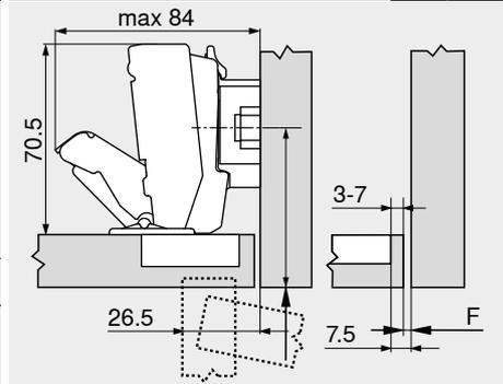
Retroceder la posición de atornillado de la base en función del espesor del frente FD +1.5 mm
