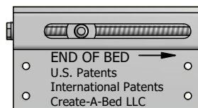
Dos (2) placas inferiores ajustables con cuatro (4) tornillos #10 x 1-5/8", cuatro (4) tuercas en "T" con tornillos para metales.
